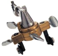
Der Schneideinsatz ist ebenfalls für Propan Art. 4501-P erhältlich, mit einem Satz zweiteiliger Propan-Schneiddüsen Art. 4520-P, bestehend aus 4521-P (3 – 20 mm), 4522-P (20 – 40 mm), 4523-P (40 – 60 mm) Art. 4500-P
